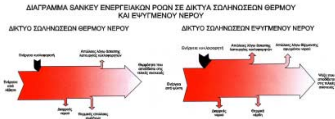
Σχήμα 4.17. Ενεργειακές ροές σε δίκτυα σωληνώσεων διανομής νερού
