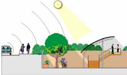
Σχήμα 8.4: «Βυθισμένοι» ανοιχτοί χώροι είναι ενδιαφέρουσα λύση για την προστασία από το θόρυβο και από τον άνεμο. Ψηλά συστήματα σκίασμού μπορούν να χρησιμοποιηθούν χωρίς να διακόπτουν τη θέα πέρα από αυτά.
