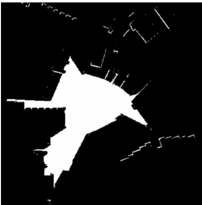
Σχήμα 4.11: Χάρτης Πεδίου Οράσεως. Χαρτογράφηση του πεδίου οράσεως από το κέντρο του χώρου. Οι άσπρες περιοχές αντιστοιχούν σε επιφάνειες μέσα στη γραμμή όρασης του παρατηρητή (Αλγόριθμος Matlab [1]).
