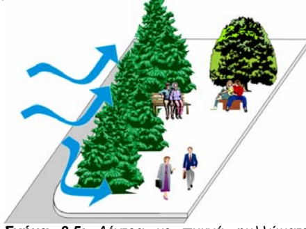
Σχήμα 8.5: Δέντρα με πυκνά φυλλώματα μπορούν να λειτουργήσουν ως ανεμοφράγματα το χειμώνα όταν τοποθετούνται στην πλευρά του επικρατούντος ανέμου.
