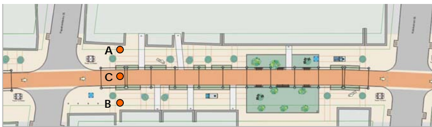
Σχήμα 10.2: Κάτοψη της σχεδιαστικής πρότασης με τις διαφορετικές περιοχές όπου αξιολογείται το περιβάλλον ακτινοβολίας (A, B και C, βλ. πίνακες δεξιά).
