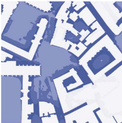
Σχήμα 4.14: Χάρτης Επιθυμητών Συνθηκών. (Από πάνω προς τα κάτω: Καλοκαίρι, Χειμώνας και Ετήσια Χαρτογράφηση). Η χαρτογράφηση των Εποχιακών και Ετήσιων Επιθυμητών Συνθηκών βασίζεται στο Προφίλ Ποικιλότητας (Σχήμα 4.13) και στην ταξινόμηση των γενικών προτιμήσεων (Πίνακας 4.1). Σκουρότερες επιφάνειες υποδηλώνουν μικρότερο βαθμό επιθυμητών συνθηκών.
