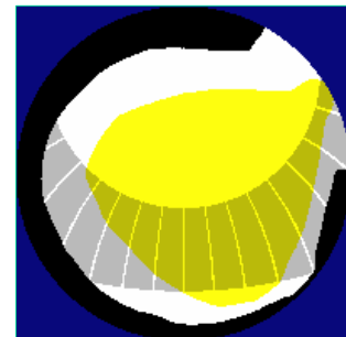
Σχήμα 6.6: Η πολυστερεογραφική προβολή του ουράνιου θόλου διαιρεμένη σε τρεις ζώνες (μαύρη= η θέα του ουρανού εμποδίζεται στο 80% και περισσότερο της επιφάνειας, κίτρινη=η θέα του ουρανού εμποδίζεται στο 20% και λιγότερο της επιφάνειας, άσπρη=το κριτήριο καλύπτεται). Τέλος, τοποθετείται σε επικάλυψη το ηλιακό διάγραμμα για την περιοχή.
