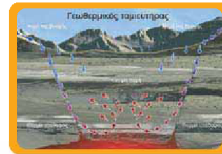
Σκίμα 12. Δημιουργία ταμειυτήρα θερμού νερού (Πηγή: Geothermal Educational Office)
