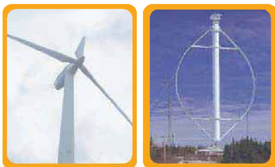
Σχήμα 8. Ανεμογεννήτριες: α) οριζόντιου άξονα και β) κατακόρυφου άξονα
