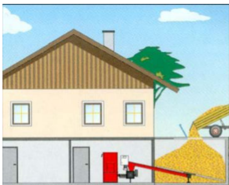
Αποθήκευση καυσίμου έξω από το κτίριο
