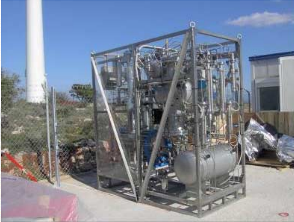
Τοποθέτηση μονάδας ηλεκτρόλυσης (Α) και συμπιεστή (Δ)
