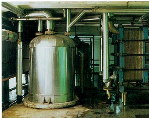
Σχήμα 14. Μονάδα συμπύκνωσης και πλακοειδείς εναλλάκτης θερμότητας
