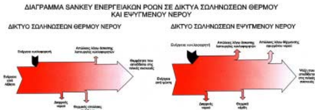
Σχήμα 4.17. Ενεργειακές ροές σε δίκτυα σωληνώσεων διανομής νερού
