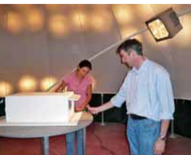
Μετρήσεις φωτισμού στον τεχνητό ουρανό
