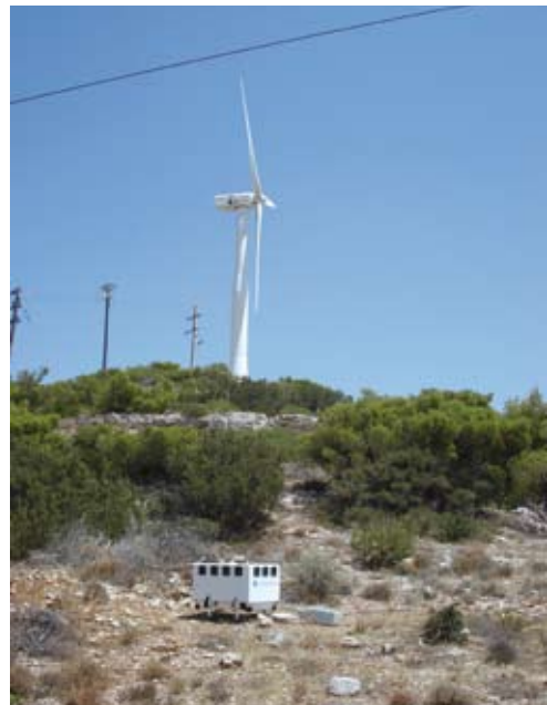
Wind Cube Laser Doppler για μετρήσεις ταχύτητας ανέμου
