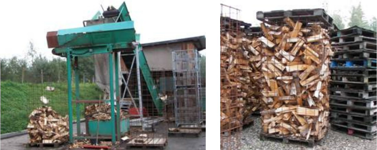
Σχήμα 3.3.1 Παράδειγμα προετοιμασίας καυσόξυλων για φυσική ξήρανση σε πλαίσια (Πηγή: Wood Fuels Handbook, BiomassTradeCentreII)
