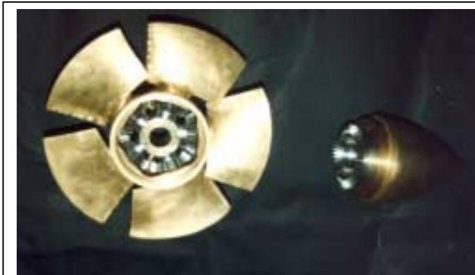
Το στροφέιο με τα πτερύγια ρυθμιζόμενης κλίσης
