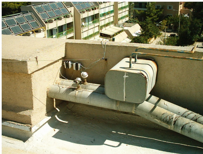
Πυρανόμετρο μέτρησης ηλιακής ακτινοβολίας
