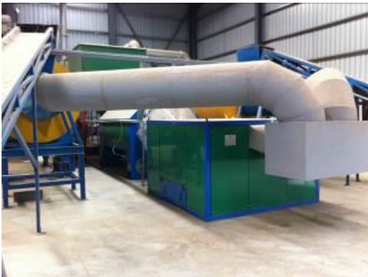
Καυστήρας 2 Gcal/h σε δύο περιστροφικά ξηραντήρια.
