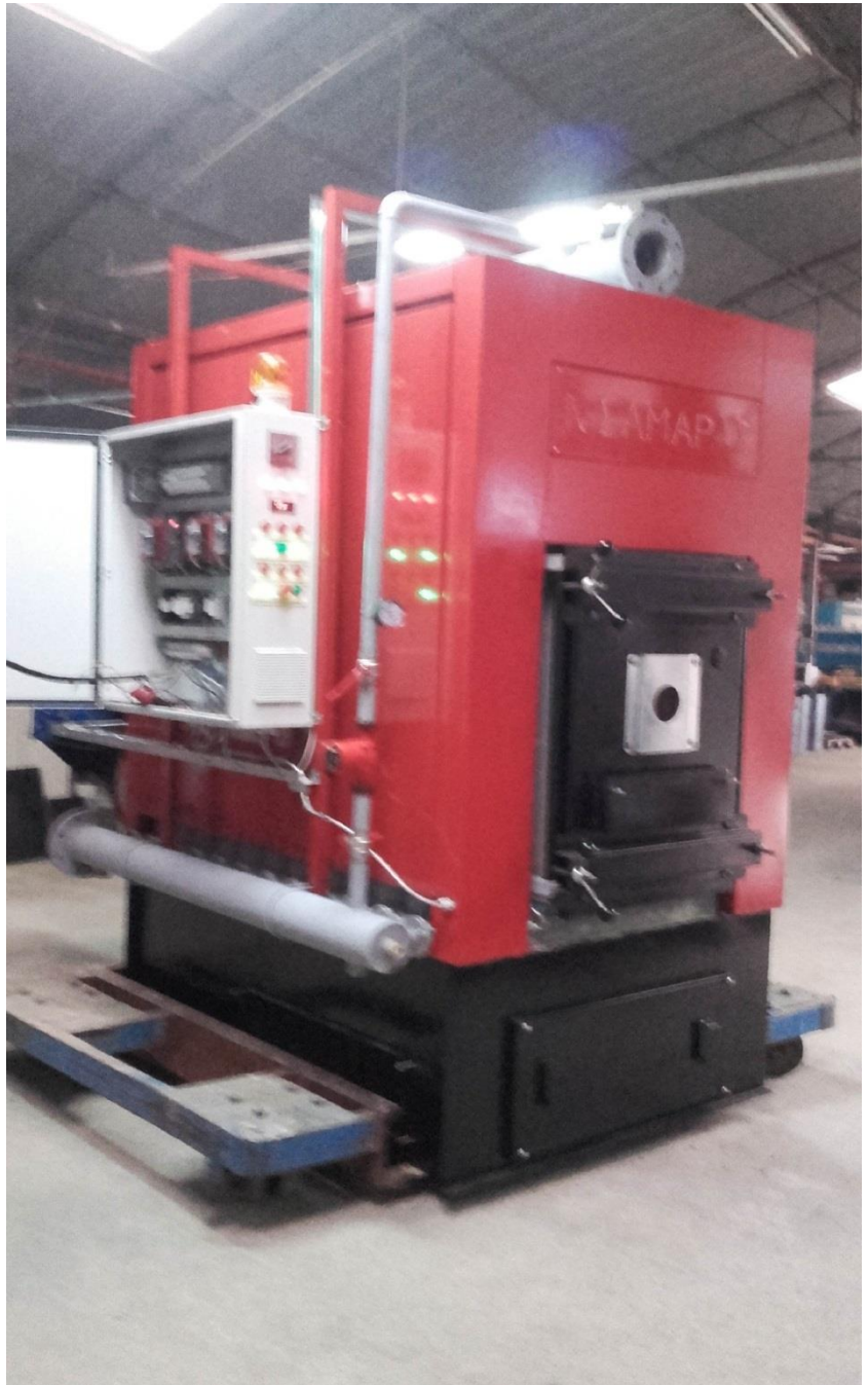
Λέβητας ισχύος 500.000 Kcal/h
