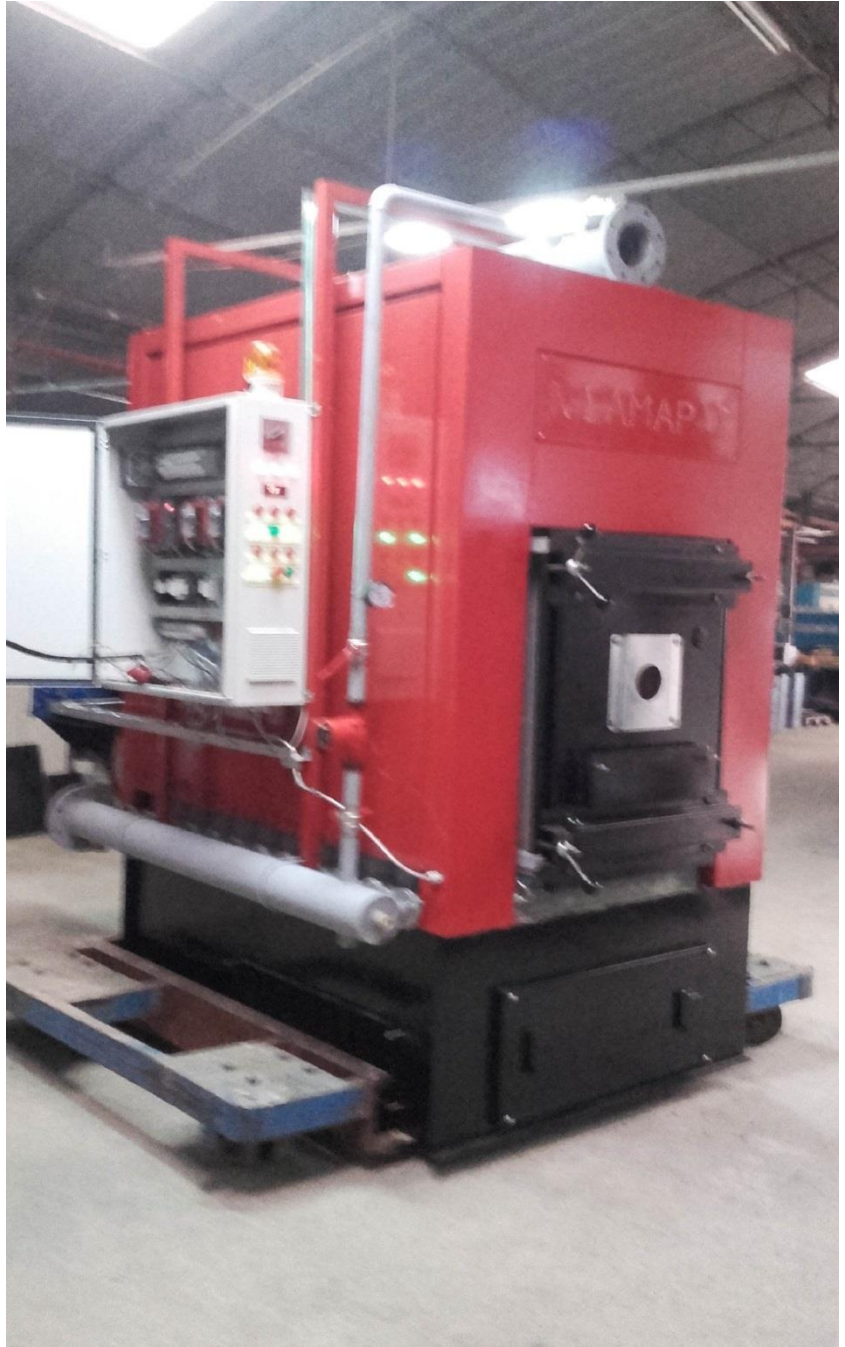
Λέβητας ισχύος 500.000 Kcal/h
