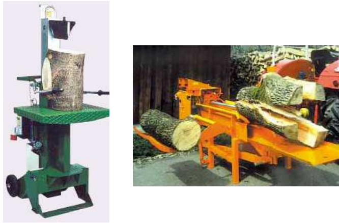
Εικόνα 4. Μηχανική σχίση με τη χρήση υδραυλικής σφήνας
