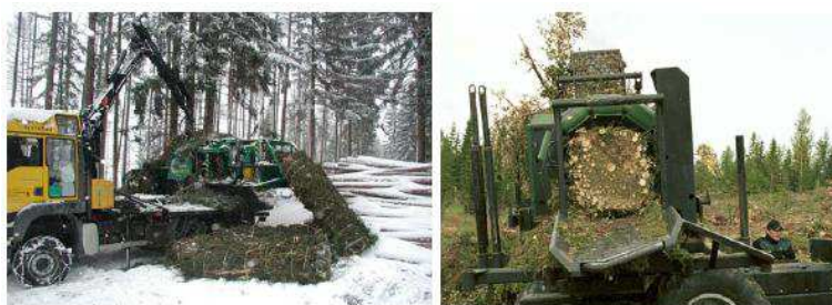
Εικόνα 9. Δεματοποίηση υπολειμμάτων συγκομιδής για παραγωγή ξύλου θρυμματισμού
