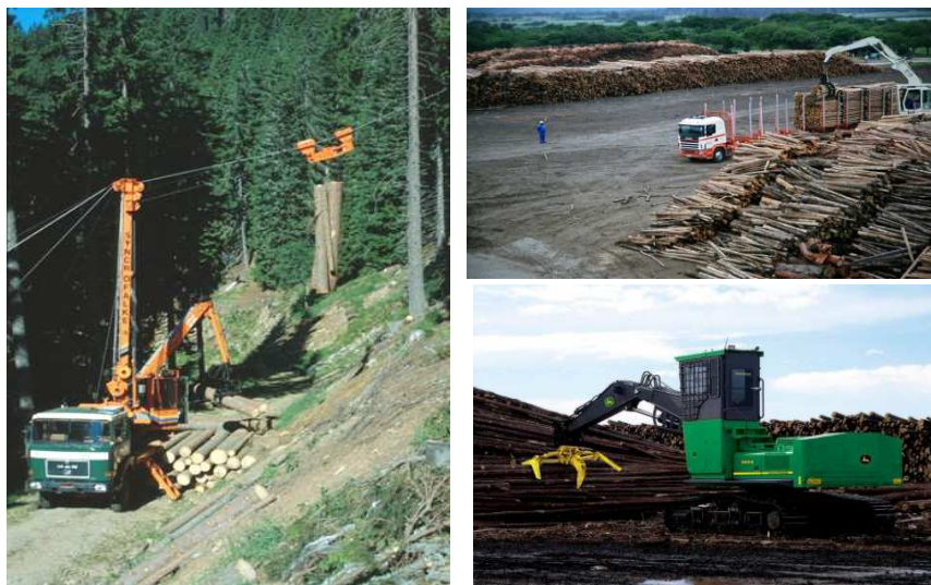
Εικόνα 3. Αριστερά: κινητός σχοινογερανός προσαρμοσμένος σε όχημα. Δεξιά: μηχανήματα φόρτωσης κορμοτεμαχίων και φορτηγό μεταφοράς
