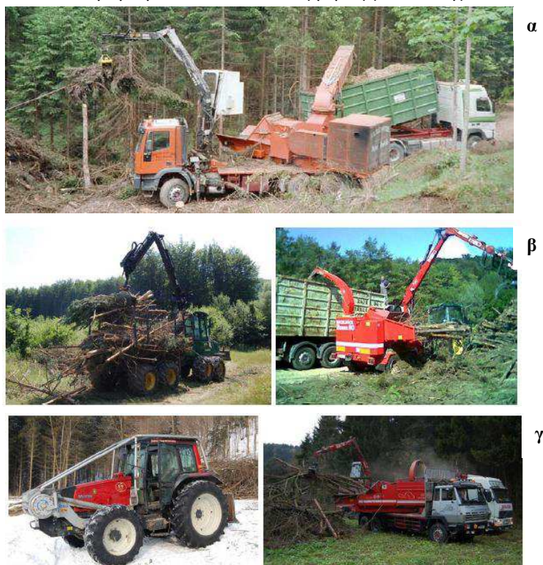
Εικόνα 7. Παραγωγή ξύλου θρυμματισμού για πηγή ενέργειας σε ορεινές περιοχές στο δασόδρομο για διάφορα συστήματα συγκομιδής (α. Ολόκληρων δέντρων β. ολόκληρων κορμών γ. σε μικρά μήκη)
