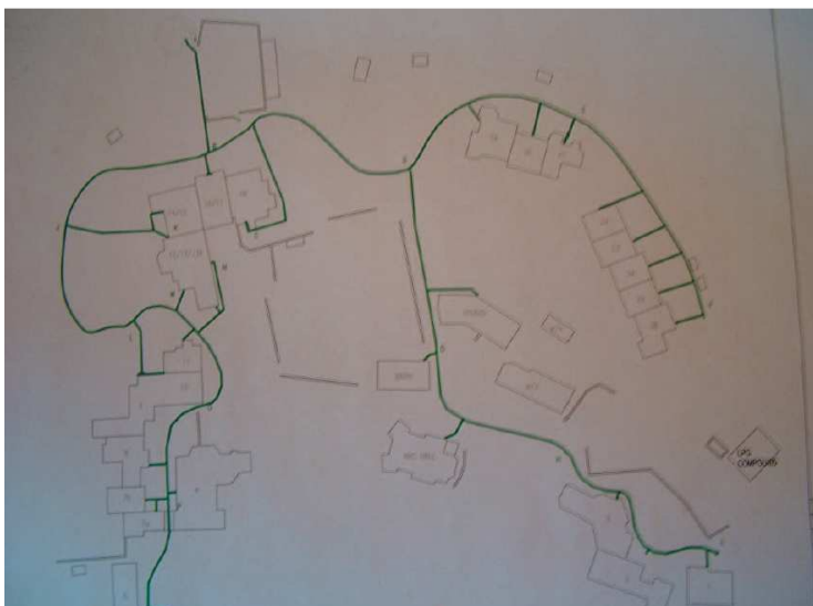
Σχήμα 2. Σχέδιο (κάτοψη) οικισμού με δίκτυο τηλεθέρμανσης.
