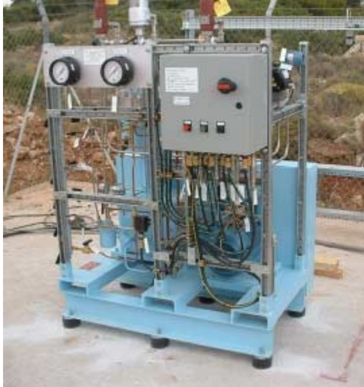
Εικόνα 2. Ο συμπιεστής υδρογόνου στο Αιολικό πάρκο του ΚΑΠΕ.
