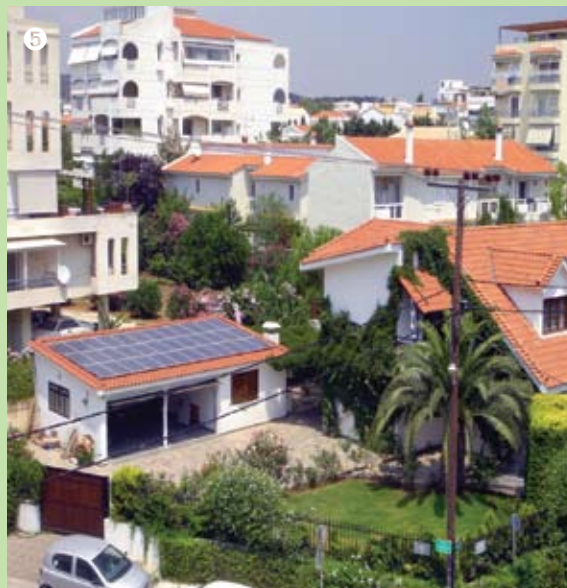
Sistema FV com potência de 6KW aplicado em casa residencial localizada na região de Voula, na cidade de Atenas.
