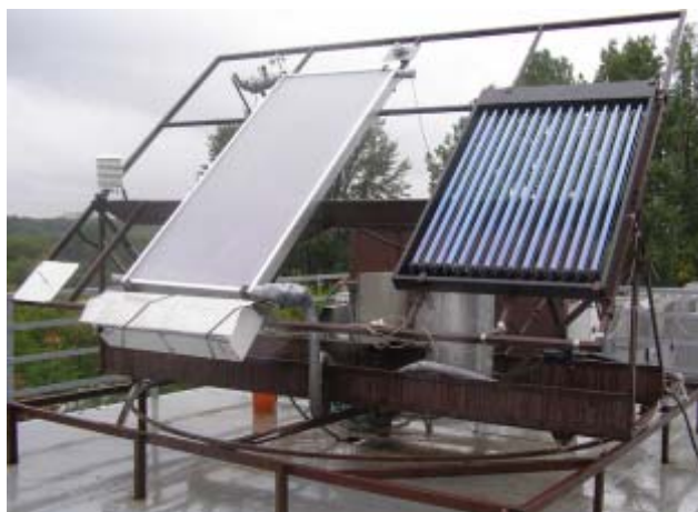
Rys. 37: Jednostka Certyfikująca Wyroby – Zakład Jakości i Niezawodności przy Instytucie Budownictwa, Mechanizacji i Elektryfikacji Rolnictwa w Warszawie, wykonująca badania kolektorów słonecznych, przeznaczonych do podgrzewania cieczy wg części normy PN-EN 12975-2:2006 z wykorzystaniem naturalnego promieniowania słońca.
