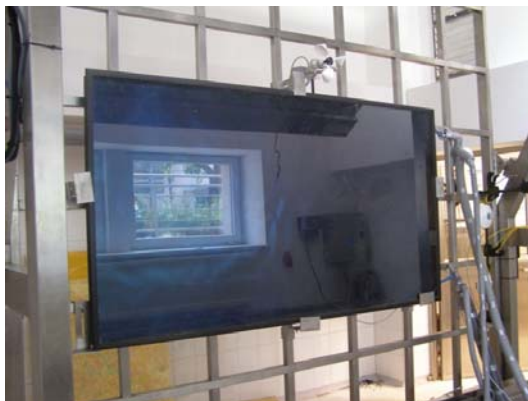
Rys. 38: Laboratorium Badawcze Kolektorów Słonecznych przy Instytucie Paliw i Energii Odnawialnej, wykonujące badania w pełnym wymiarze wymaganym przez normę PN EN-12975:2006.
